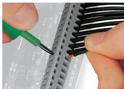
通过3.5mm螺丝刀插入导线。
