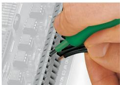
通过3.5mm螺丝刀插入导线。
