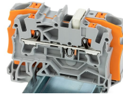
高低跨接器 (2006-499) 可将6/4mm 2 (10/12AWG) 接线端子 (2206/2204系列) 与4/2.5/1.5mm 2 (AWG12/14/16) 接线端子 (2204/2202/2201系列) 进行跨接。
