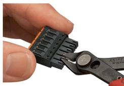
孔型连接器的防插错装置, 通过扭断防插错定位销。
