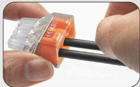
如需拆卸，一边来回转动电线，一边向外拨移接线头
